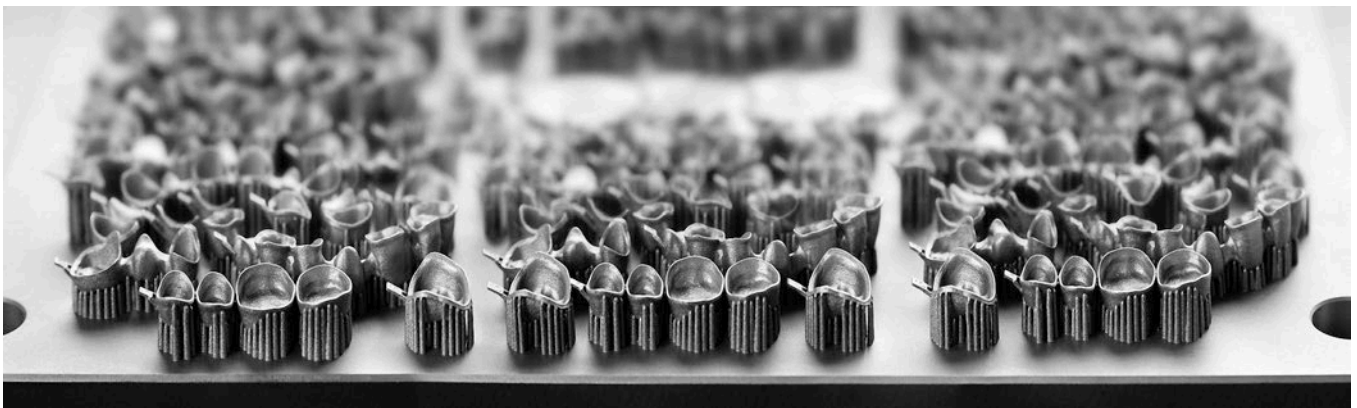
Abb. 1 Kronen- und Brückenarbeiten im Lasersinterverfahren.
