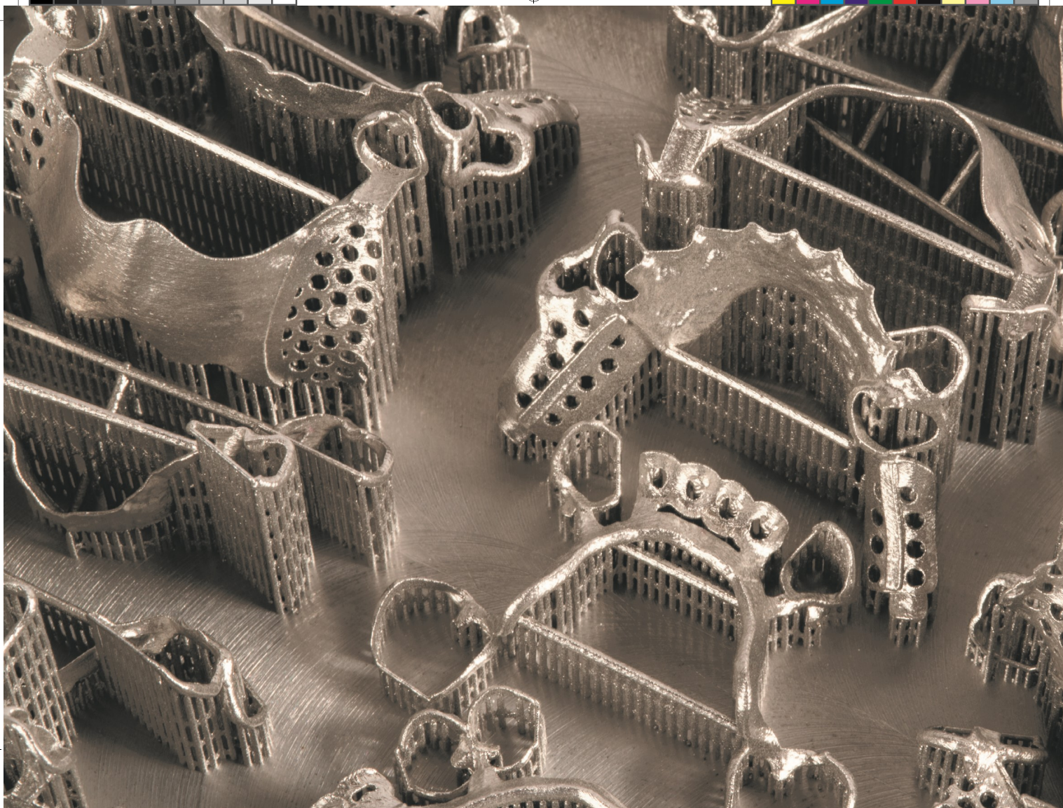
Foto 8. Gietmodel met steunstructuren op bouwplaat
