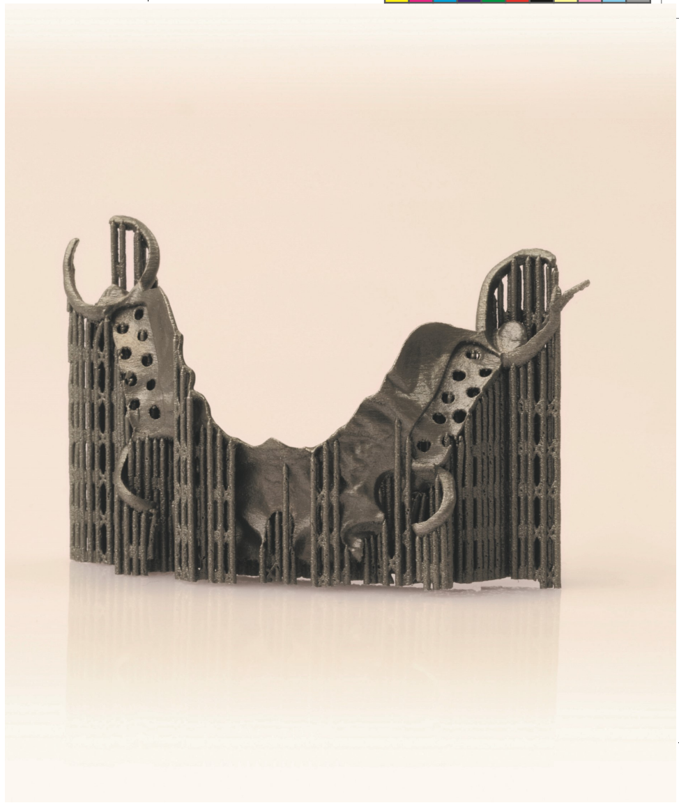
Foto 9. Gietmodel met steunstructuren na spanningsarm gloeien
