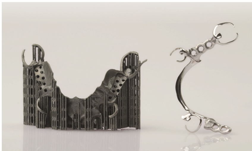
Foto 4a. Modelgieten lasergesinterd – met support-structuren en nabewerkt
