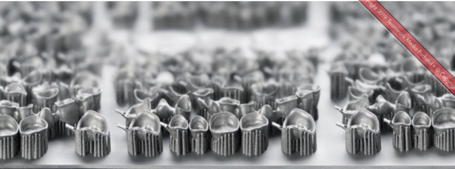
Einer der Vorteile des Lasersinterverfahrens ist, dass mit einem Fertigungsprozess viel mehr Bauteile generiert werden können. (© EOS GmbH)
