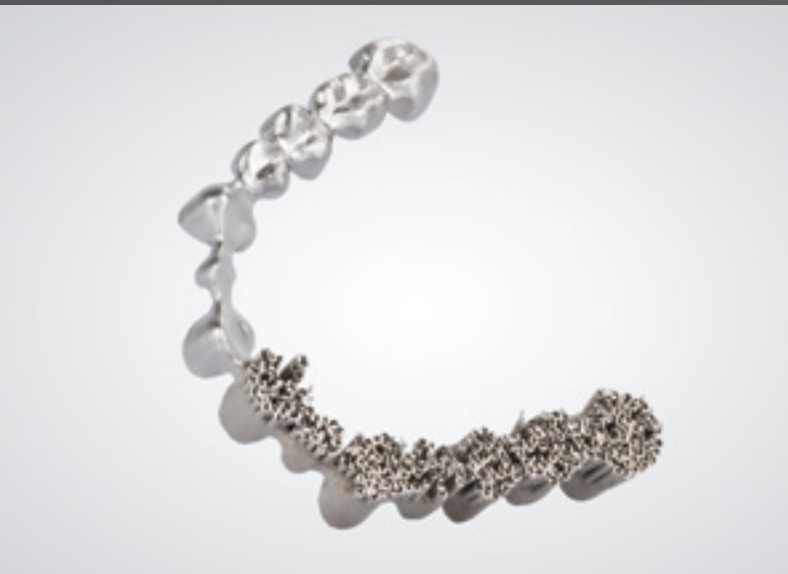
14-gliedrige Brücke, die mittels Lasersinterertechnologie hergestellt wurde: Unten ist die noch unbearbeitete Brücke mit den Support-Strukturen und oben die ausgearbeitete Brücke dargestellt. (© EOS GmbH)
