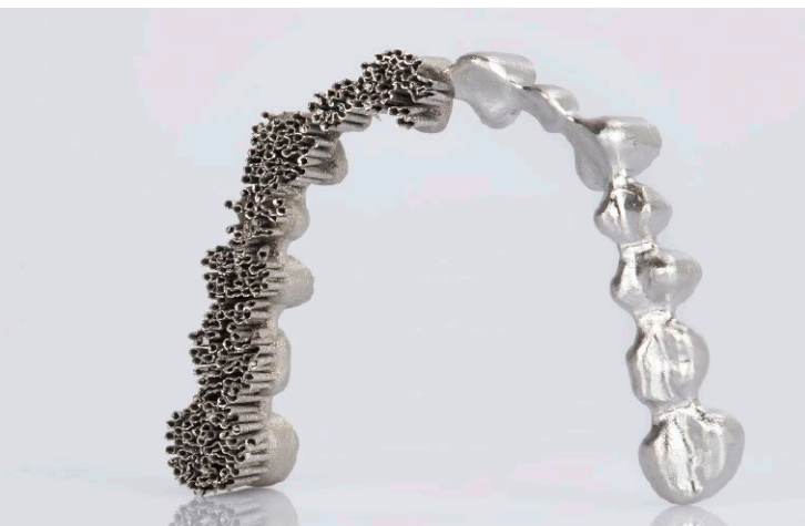
◉ 14-gliedrige Brücke mit Lasersinter-technologie hergestellt. Linke Seite: inklusive Supports, rechte Seite: Supports entfernt und nachpoliert.
