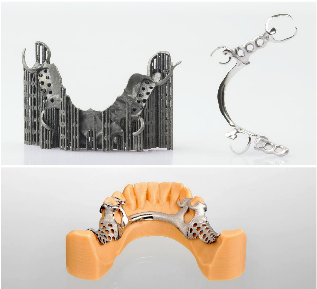
□ Modellguss lasergesintert – mit Support-Strukturen und nachgearbeitet (Bild oben) und zentral gefertigter Modellguss (Bild unten)
