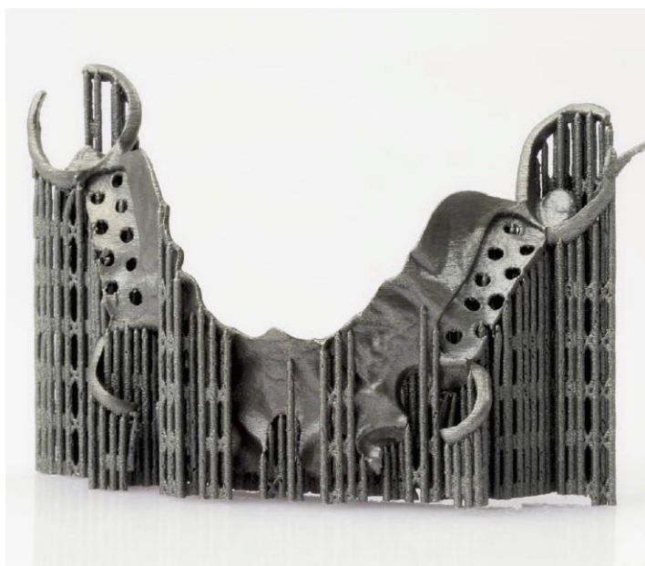
□ Modellguss mit Stützstrukturen nach Spannungsfreiglühen
