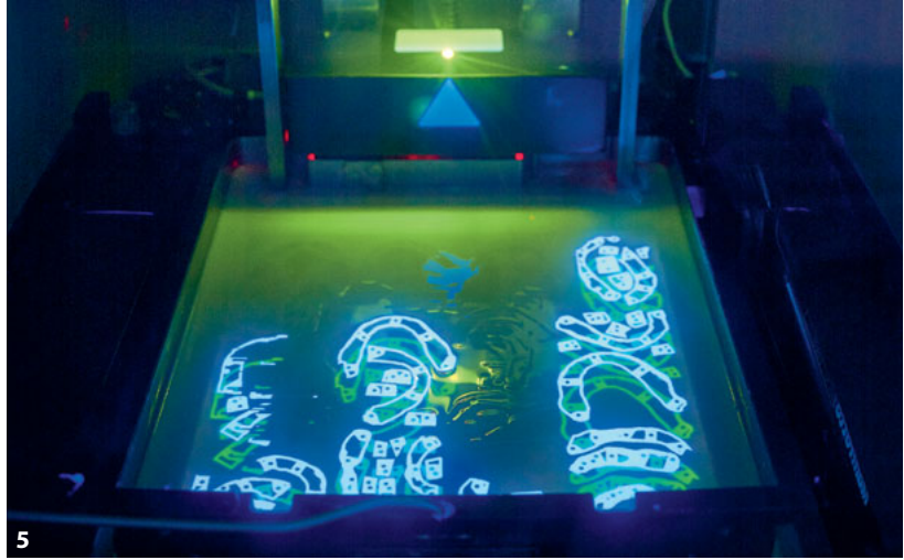
Abb. 4 Leider keine Seltenheit: unzureichende digitale Abformung: a Abformung aus Sicht des Zahnarztes, b problematische Umsetzung beim Einbringen des Laboranalog aufgrund fehlenden Bildmaterials. Abb. 5 Digitale Modellherstellung bei Infindent: Bauprozess von Dentalmodellen auf Basis der Stereolitografie.
