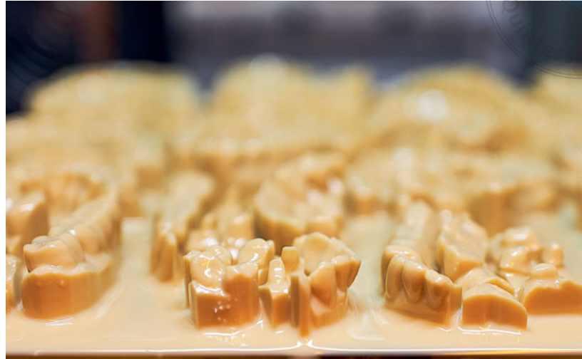
Abb. 6 Industrielle digitale Modellherstellung im SLM Verfahren. Bis zu 40 Modelle werden in ca. zwölf Stunden additiv gefertigt.
